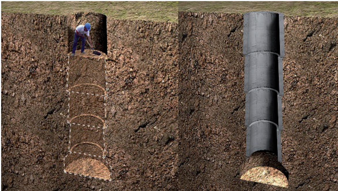
Figura N° 1. Proceso de profundización y sostenimiento por anillos del pozo austríaco
