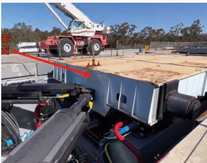
Figura 8. Mesa vibratoria equipada con pistones hidráulicos para emular un sismo. (nheritallwood.mines.edu, 2024)
