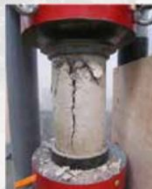
Figura 8. Ensayo de rotura de una probeta de hormigón. (García F., 2014)
