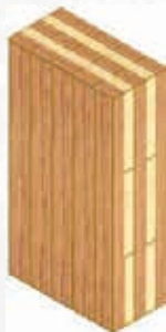
Figura 5. Sección transversal y vista isométrica de un elemento conformado de madera laminada. (www.maderea.es, 2024)
