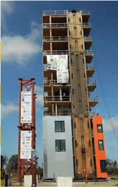
Figura 10. Prototipo del edificio de 10 niveles listo para ser ensayado en la mesa vibratoria. (nheritallwood.mines.edu, 2024)
