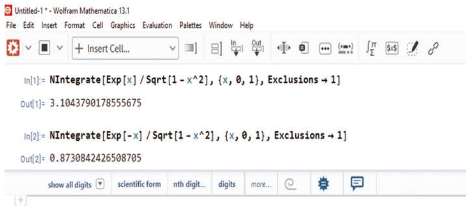
Figura 4. La interfaz de cálculo de los valores principales de Cauchy de las integrales impropias \int_0^1 \frac{e^x}{\sqrt{1-x^2}} dx y \int_0^1 \frac{e^{-x}}{\sqrt{1-x^2}} dx con la aplicación de computación algebraica Mathematica v.13.1
