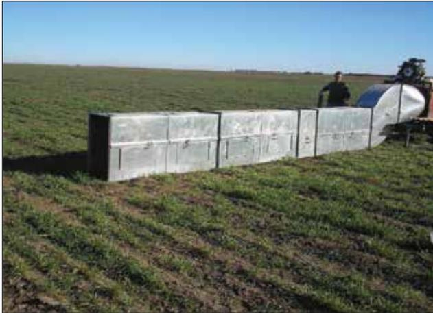
**Figura. 1.** Túnel de viento portátil
