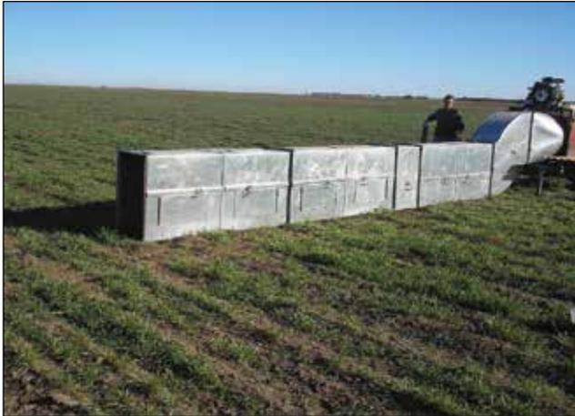
**Figura. 1.** Túnel de viento portátil
