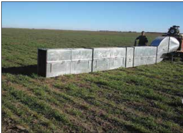
Figura 1. Túnel de viento portátil
