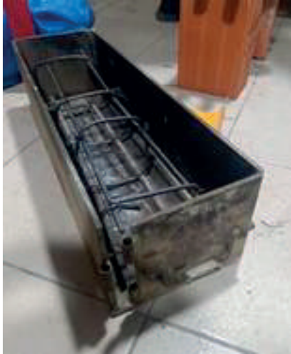
Figura 6: Armadura de viga sin refuerzo de Bambú.
