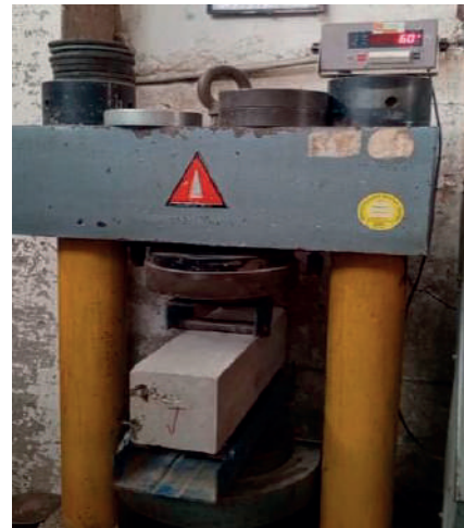
Figura 8: Aparato usado para el ensayo a flexión.
