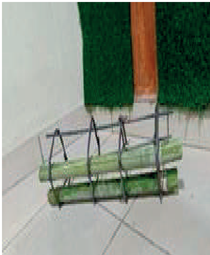
Figura 7: Armadura de viga con refuerzo de Bambú.
