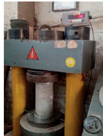
Figura 9: Aparato usado para el ensayo a compresión.
