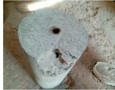
Figura 10: Modo de falla de la probeta cilíndrica con la implementación del bambú tacuara.
