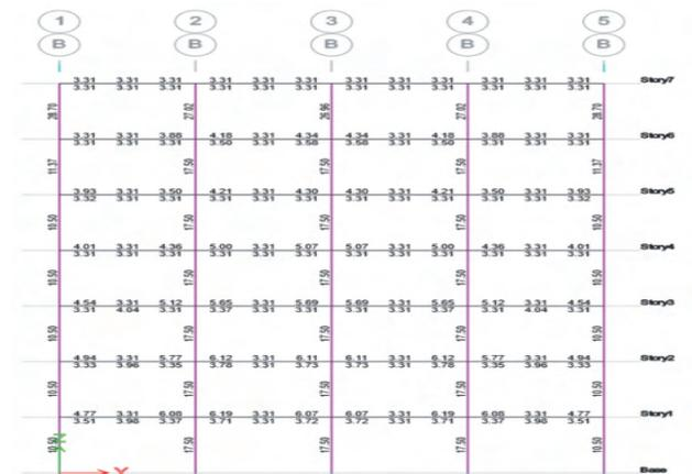
Figura 1.7: Cuantías en las columnas y vigas del Modelo MOD-CAR (Concreto Alta Resistencia H40 Mpa.)
