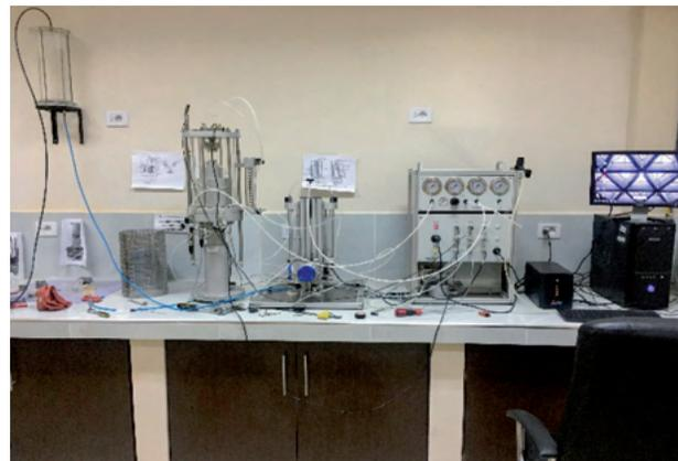
**Figura 3.** Equipo triaxial de suelos no saturados
