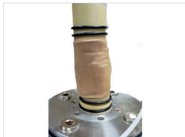
Figura 7. Rotura de muestra.
