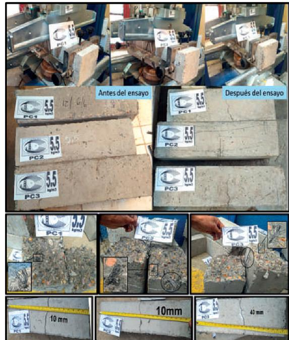
**Figura 21.** Vigas ensayadas e inspección visual
