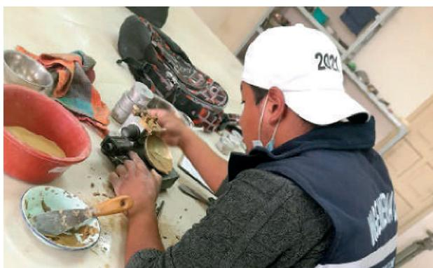
Figura 14: Ensayo de Límites de Atterberg
