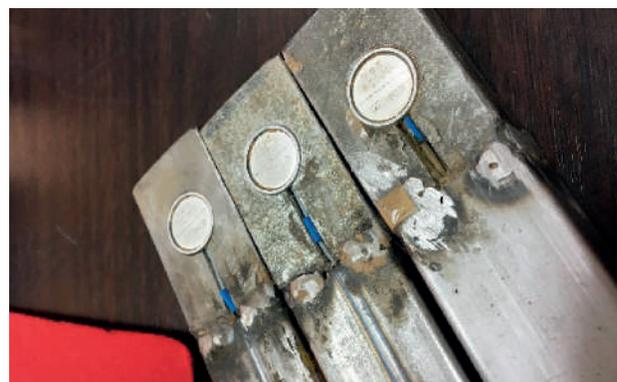
Figura 3. Protectores de las células de carga.
