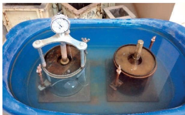
Figura 19: Medición de la expansión
