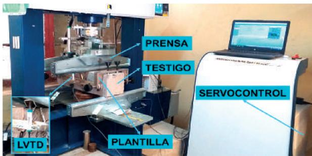
Figura 6. Equipo de Ensayo
