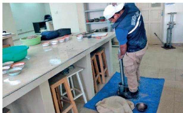
Figura 17: Ensayo de compactación T-180
