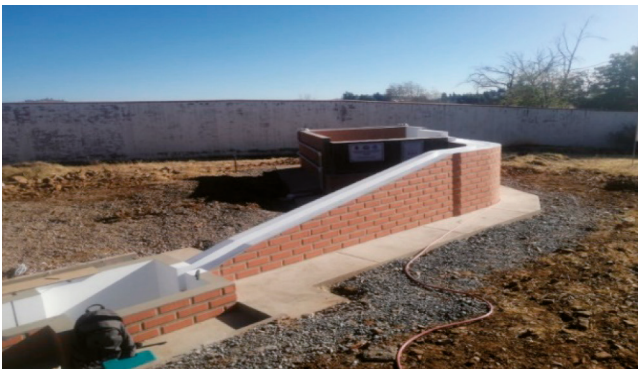
Figura 3 Modelo físico del aliviadero escala 1:30 construido
