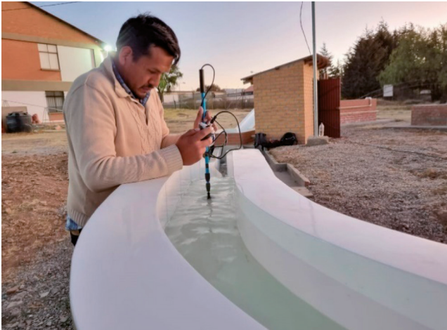
Figura 11 Medición de la velocidad con molinete
