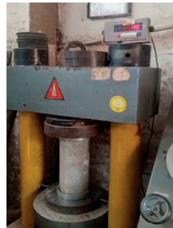
Figura 9: Aparato usado para el ensayo a compresión.
