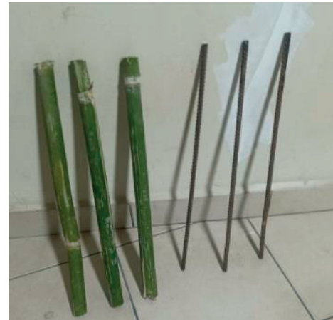
Figura 5: Barras de acero y bambú de 0.45m de longitud.
