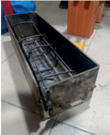
Figura 6: Armadura de viga sin refuerzo de Bambú.
