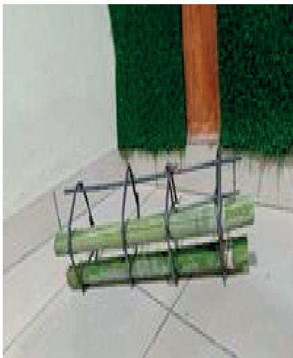
Figura 7: Armadura de viga con refuerzo de Bambú.
