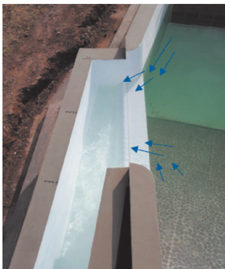
Figura 7 Vectores de flujo en el modelo físico
