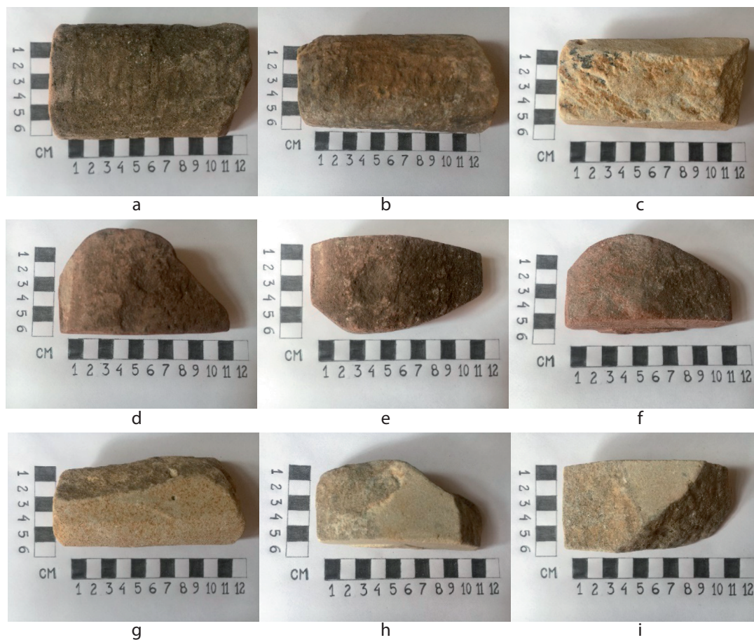
Fig. 4. Especímenes divididos en tres grupos: a, b, c - grupo I (visualmente presentan el mayor grado de deterioro); d, e, f - grupo II (muestran deterioro parcial) y; g, h, i - grupo III (visualmente no hay deterioro físico).
