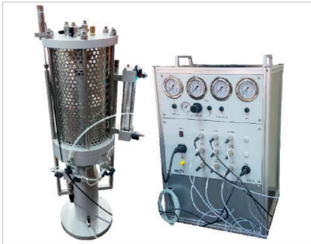
Figura 1. Equipo triaxial y módulo de control.
