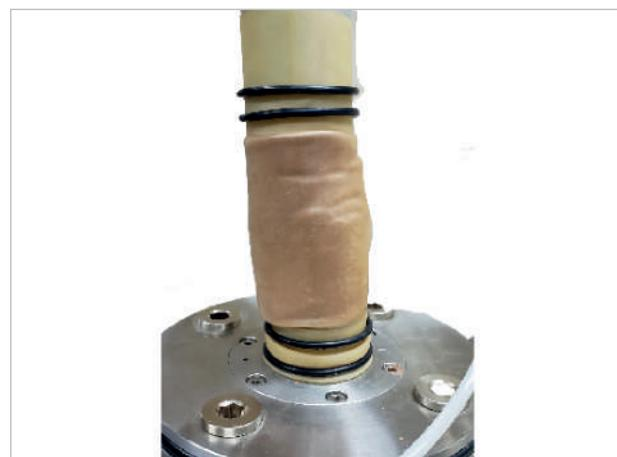
Figura 7. Rotura de muestra.
