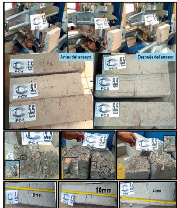
Figura 21. Vigas ensayadas e inspección visual
