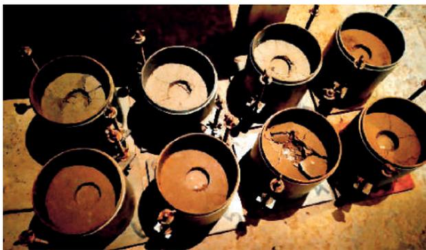
**Figura 20:** Ensayo de penetración CBR
