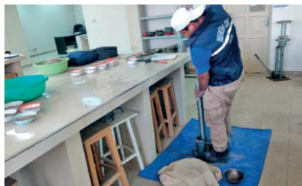
Figura 17: Ensayo de compactación T-180
