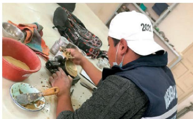
Figura 14: Ensayo de Límites de Atterberg
