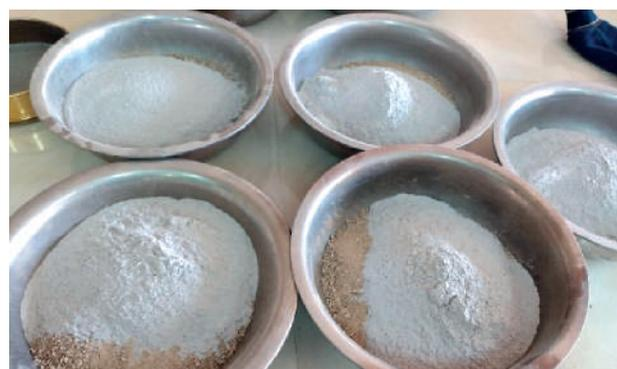
Figura 16: Dosificación suelo – cenizas de carbón
