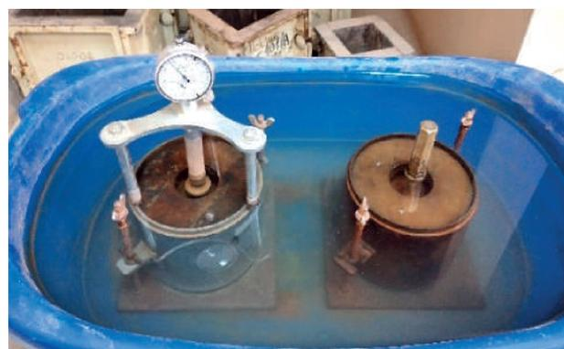
Figura 19: Medición de la expansión
