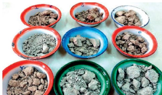
Figura 18: Muestras secado en horno
