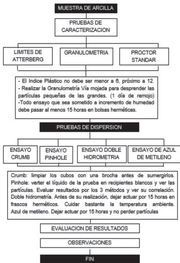
Esquema 1. Ensayos de laboratorio.
